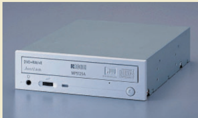
リコーのDVD+R/RW対応内蔵ドライブ「MP5125A」。価格は実勢で約3万9,800円。DVD+R/RWはソニー、フィリップス、リコーなどによって独自に提案された書き換え可能なDVD規格で、DVDフォーラムの標準規格にはなっていない。
