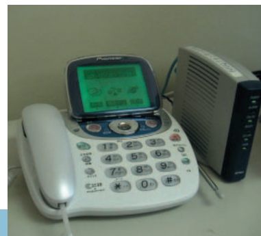
FTTHサービスのメディアコンバーターにBBIQフォンターミナルを取り付けて、電話機をつなげればいい。
