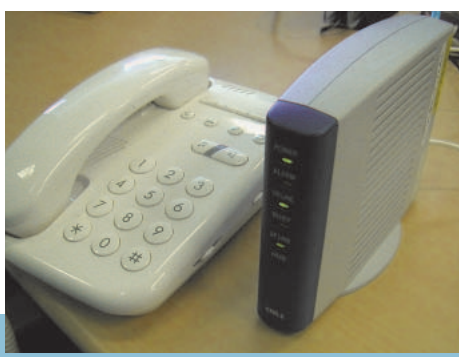
<遅延のテスト環境> 遅延テストは、公衆回線とWAKWAKコール・ゴーゴーの両方で、同じテレフォンサービスに通話してその時間差を計測した。波形はノイズが多く含まれているが、これはモジュラージャックから音声信号を取り出す際に乗ってしまったもので、実際に受話器から聞こえる音とは異なる。
