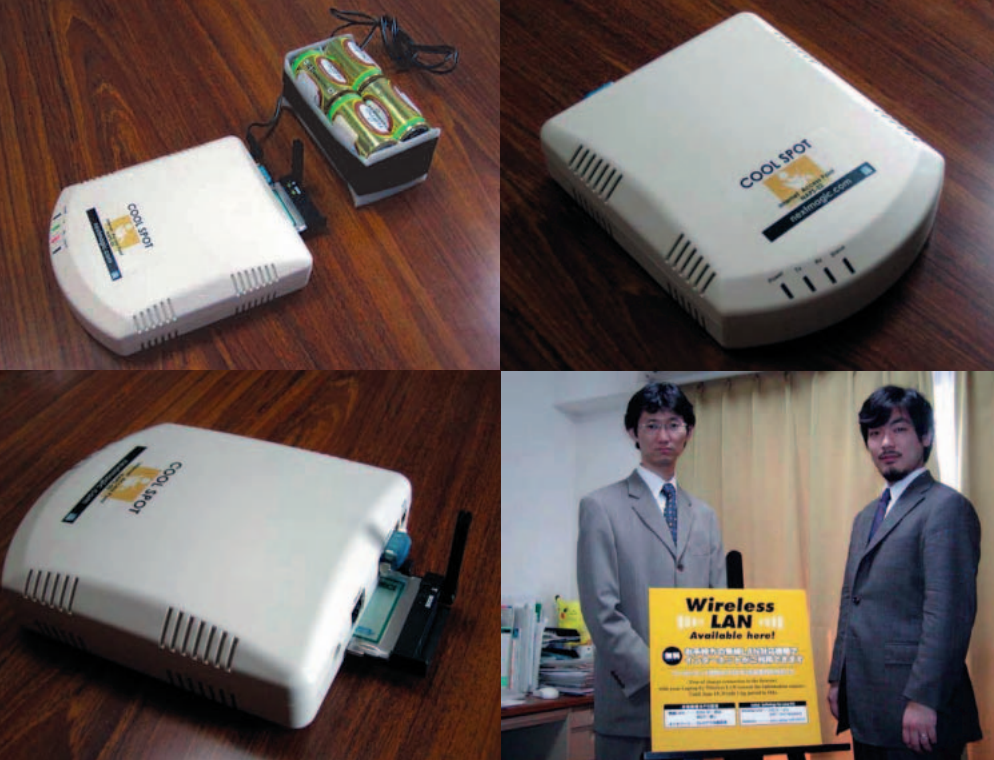
[ 左上 ]単1アルカリ乾電池8本で1日程度の運用が可能(これはデモ用、サービス時にはより小型のバッテリーも検討する) [ 右上 ] COOLSPOT専用の無線ルーター「NAPS-02」設置面積は14.5cm × 22cmのほぼA5サイズで、重さは480g。 [ 左下 ]WAN側のネットワークは現在のところAirH ® とb-mobile(スロット自体はFOMAにも対応) [ 右下 ]萩原州代表取締役社長(右)と郷野将輝常務取締役(左)
