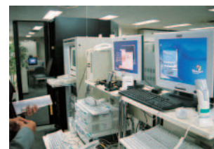
(上)日立製作所が法人向けに売り出しているウィンドウズCE.NET搭載のPDA。802.11bの無線LAN機能を内蔵している。(下)沖電気が開発した.NET対応のテレコミュニケーションシステム「CTstage 4i」の構成モデル。PDAによるVoIPで社内のIPネットワークを使って会話ができる。
