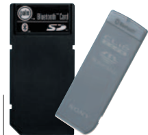
SD型、メモリースティック型 Bluetoothモジュール (IEEE802.11bモジュールも登場するか!?)
