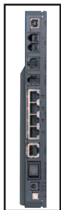
RTA54iの背面部。イーサネットはWAN側1ポート、LAN側4ポート。このほか、ISDNへの接続に使うモジュラージャックや、TAとして使う場合のUSBポートが備えられている。
