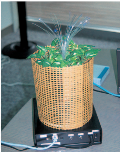
センサーが人の動きを感知すると先方のファミリープランター装置部分の光ファイバーが光り回転する。
