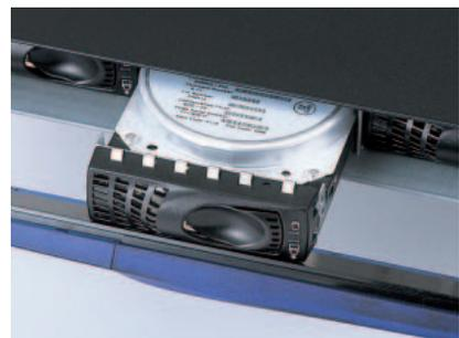
前面アクセスに対応したベイを備えるラックマウントサーバーでは、このようにHDDを交換できる。ホットスワップに対応していれば、電源が入ったままでも抜き差し可能だ。(写真はCobalt RaQ XTR)
