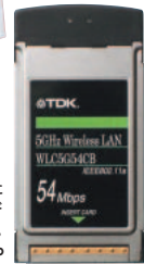
アセロス社のチップセットを使ったTDKの5GHz LAN対応PCカード(開発中)。 www.tdk.co.jp
