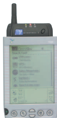
OmniSky向けにCNNやUPSなどによる各種のモバイル用コンテンツが提供されている。モデム上部の赤ランプはメール受信のシグナル。
