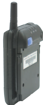
Visor用Minstrelワイヤレスモデム本体。かなりうしろに出張るデザインになっている。モデムに内蔵の電源は充電式。
