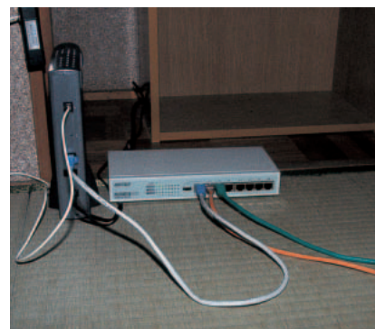
ADSLモデムとハブは意外と大きい。モジュラージャックの近くに置き場所を用意しておこう。
