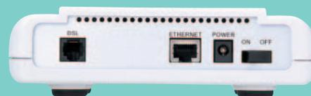
イーサネット、モジュラー、ACアダプター、電源スイッチだけのシンプルな背面。
