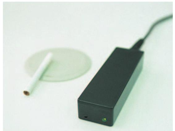
サーバー機能も有する温度センサー。コンパクトな作りながら、これ単体で直接インターネットに接続できる。電力はケーブルから供給される。
