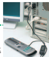
クロッサム2PlusとPCは、オプションで販売されているシリアルケーブルで接続する。
