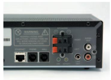
特徴的な本体裏面のジャック群。HomePNA対応のため、電話線がささるようになっているが、モデム機能は内蔵されていない。
