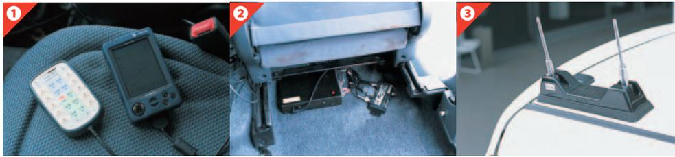
①車内ではウィンドウCE搭載のPDA（右）で情報を見る。左は車の状態を送信するための動態スイッチ。②車載機本体（左）とアンテナにつながるモバイルアーク（右）は座席下に設置する。③車載アンテナ。基地局との送受信にはDoPa回線を用いる。
