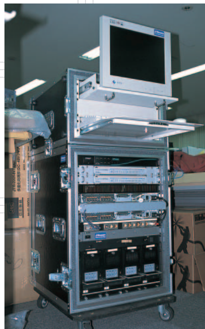
Jストリームのライブ中継で活躍するエンコード専用マシン。これまで培ってきた独自のノウハウが詰まっており、どんな場所からでも迅速にストリーミングのエンコードができる。こうしたノウハウの蓄積もストリーミングを進化させる。
