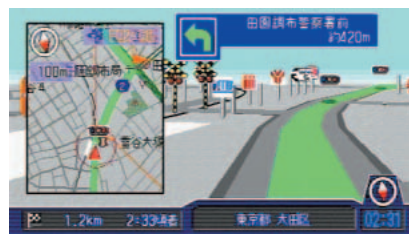
運転席から見る目線の状態で3D地図を表示するパイオニア CARROZZERIA AVIC-D9500の「ドライブスビュー」。
