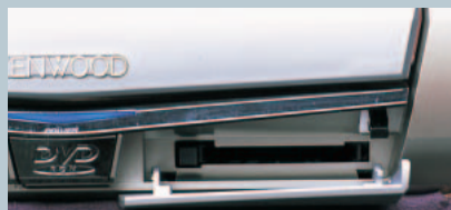
ケンウッド DVZ-2000TVP+ 前面のコンパクトフラッシュカードスロット。地点登録用だが、将来的な機能拡張としても利用が検討されている。
