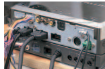
CARROZZERIA AVIC-D9500の背面。下段の左奥から2つ目が携帯電話用のポート。
