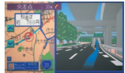
高速道路の入り口付近を緻密な立体拡大図でわかりやすく表示する「3D都市高速入口ガイド」(NAVIRA DV-D30S Plus)
