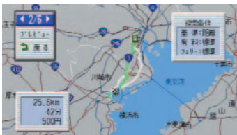
有料道路があるかないか、距離や幹線道路を組み合わせて最大6本のルートの同時探索ができる(CARROZZERIA AVIC-D9500)
