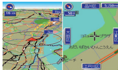
独立型ツインマップ機能を持つソニー NVX-DV733の画面。中央のリモコンマークの向いている側が操作できる。
