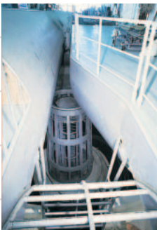
第1回(1998年8月号) 光ケーブル敷設船に秘められた過去 (数千キロのケーブルを積み込むケーブルドラム)
