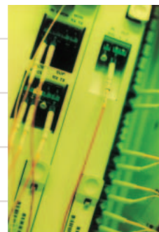
第11回 (1999年9月号) 1本のファイバーに数十波を詰め込む「波長多重中継装置」のミクロな仕事
