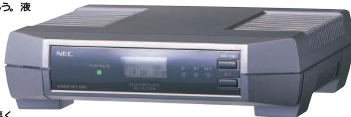
一見わかりにくい、左下部に10BASE-Tポートのフタがある。2つの機能ボタンは任意に設定でき、初期状態では接続/切断や着信履歴表示に設定されている。
