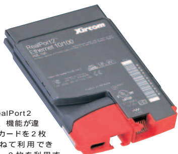
コネクターが本体に接続されているので、ケーブルが直接接続できる。
