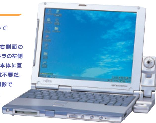
従来モデルよりもサイズがひと回り大きくなったが、液晶画面の大型化、キーピッチの拡大、ポインティングデバイスの改良などにより操作性は向上している。
