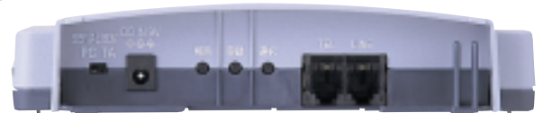
ワイヤレスステーション底面：ワイヤレスステーション底面に AC アダプターや電話回線を接続するコネクタが配置されている。
