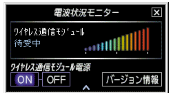
電波状況モニター：画面左下のスイッチを「ON」にするとワイヤレスステーションと通信できる。
