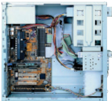
5.25インチベイに4台と3.5インチベイに3台のデバイスを内蔵できる。空きベイには、ハードディスクや磁気テープドライブなどを増設できる。
