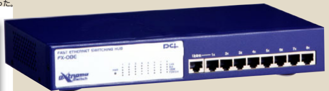
ブラネックスコミュニケーションズのスイッチングハブ「FX-08E」。これも10BASE-T/100BASE-TX対応。実勢価格2万円程度。
