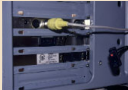
光ファイバーケーブルを直結できるイーサネットカード（中）とケーブル。
