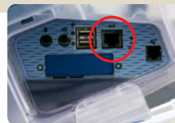
iMacのイーサネットポート。形状は電話線を差し込むところと似ている。イーサネットポートは「LANポート」と記載されている場合もある。
