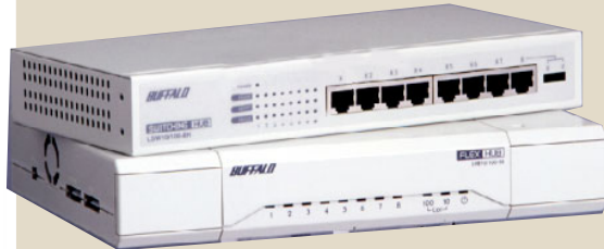
メルコのスイッチングハブ「LSW10/100-8H」(上)とデュアルスピードハブ「LHB10/100-S8」(下)。どちらも10BASE-T/100BASE-TX対応。実売で3万円を切った低価格は、数年前には考えられなかった。
