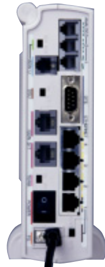
各コネクタ部分と同じ色のケーブルを差し込んで設定するカラー配線を採用。背面左上から下へ極性反転スイッチ、U点、DSU無効化スイッチ、S/T点2つ、終端抵抗切り替えスイッチ、電源スイッチ、アース端子、右上から下へアナログポート3つ、シリアルポート、10BASE-Tポート4つ、LAN切り替えスイッチ。
