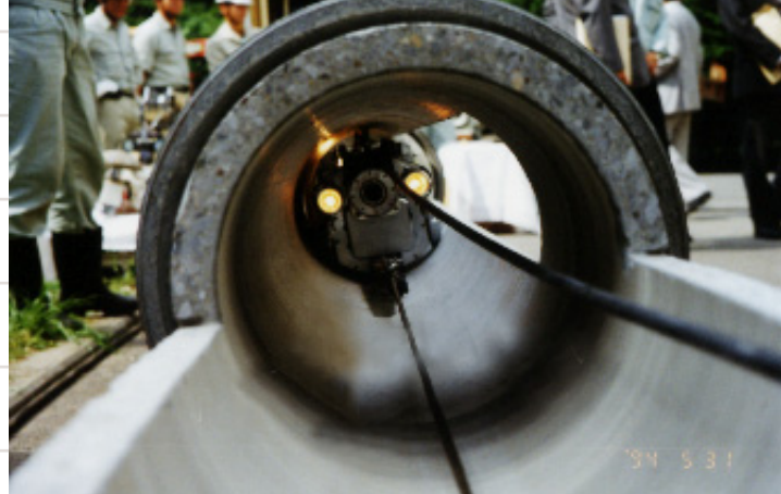
'94年、最小型ロボットで完成で行われた公開実験の様子。下に付いているケーブルはロボットを牽引するためのもの。
