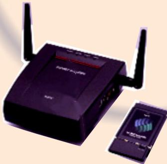
NECが開発した「Radio8300シリーズ」は、IEEE 802.11 準拠のFHSS方式の無線LANだ。無線LAN PCカードとアクセスポイントがあり、無線LAN PCカードのみのネットワークとアクセスポイントを使った有線LANとの接続の双方のモードを持つ。IEEE 802.11 準拠のFHSS方式
