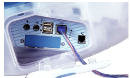
iMacのイーサネットポート。イーサネットケーブルでケーブルモデムと接続する。
