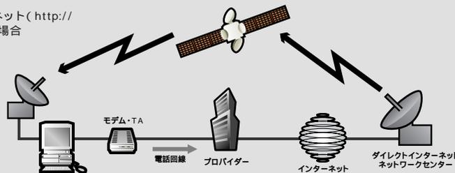
イトを見たい」というリクエストが「上り」のデータとしてモデムやTAを使って送信されます。そして該当するサイトのデータは衛星にデータを送るための「ネットワークセンター」に送られ、衛星を経由してユーザーのパラボラアンテナに中継されるのです。
