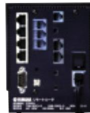
写真左上から下へ、10BASE-Tポート4つ、RS-232Cポート。中央左上から下へ、アナログポート3つ、アース端子。中央右上から下へ、U点、DSU切り離しスイッチ、S/T点2つ、終端抵抗切り替えスイッチ、LAN切り替えスイッチ。右上から下へ、電源スイッチ、電源。
