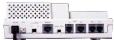
写真左から、電源、アース端子、LAN切り替えスイッチ、10BASE-Tポート、極性反転スイッチ、U点、S/T点、アナログポート2つ。
