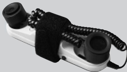
壁や電話機からモジュラーケーブルがはずせないときの最終兵器、音響カプラー。周囲の音や設定がデリケートなので、使用時は説明書を熟読しよう。14000円程度
