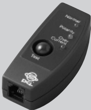
PCI（プラネックスコミュニケーションズ）製のモデムプロテクター。本文にあるように電話回線の極性などのチェックを行うチェッカー。大きさはタバコの箱より一回り以上も小さいものだ。3000円程度
