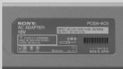
ACアダプター本体にある対応電圧(ここではINPUT)を確認しよう。渡航先の国の電圧がこれ以下なら問題なく使えるはずだ。
