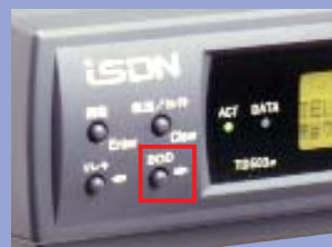
アレクソンのTD503 前面にあるBOD手動切り替えボタン(右下)。
