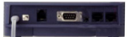
背面。右から、S/T端子2つ、RS-232Cポート、ISDNポート、アース端子。
