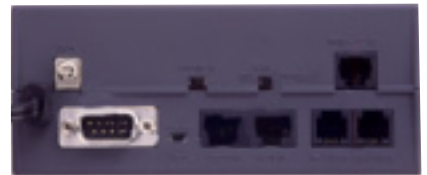
背面。左上から右に、アース端子、極性反転スイッチ、DSUのON/OFFスイッチ、ISDNポート。左下から右に、RS-232Cポート、終端スイッチ、S/T端子2つ、アナログポート2つ。
