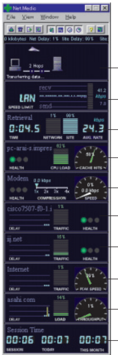
NetMedicのモニター画面。 アクティビティパネル スループットパネル 読み取りパネル クライアントパネル モデムパネル イン トラネットパネル ISPパネル インターネットパネル サーバーパネル 接続時間パネル
