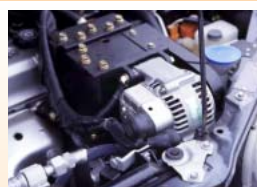
コンピュータやボード、通信機など電源が必要な機器を車に積むので、電源供給用のダイナモを2機搭載している。
