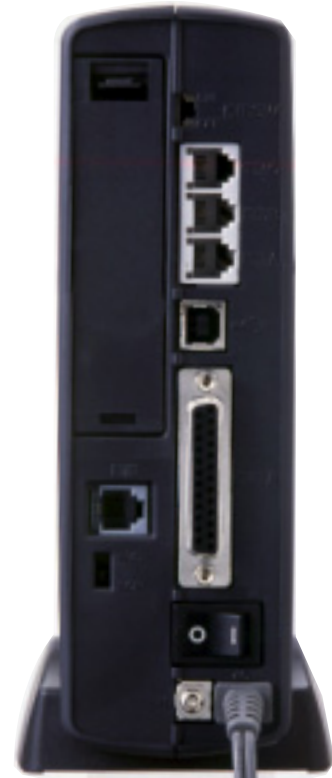
背面。右上から停電スイッチ、アナログポート3つ、USBポート、RS-232Cポート、電源スイッチ。左はISDNポートと極性反転スイッチ。
