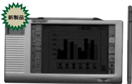
④ 画面はモノクロだがパワーザウルスに負けない高性能の新製品ザウルスポケット MI-110M
