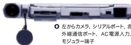
③ 左からカメラ、シリアルポート、赤外線通信ポート、AC電源入力、モジュラー端子
