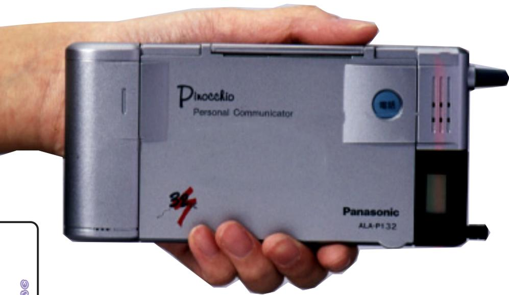
ピノキオは、PHSの32Kデータ通信のPIAFSを内蔵したPDAだ。つまり、データ通信もPHSでの電話もこれ1台で行うことができる。ピノキオの電子メールソフトではMIME形式がサポートされているため、添付ファイルの送受信も行える。手書き文字の電子メールをイメージに変換してメールに添付することができる。このほか、インターネットのWWWブラウザも内蔵しているが、テキストにしか対応していない。
