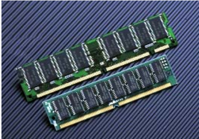
32Mバイト DIMMメモリー（写真上）と、16Mバイト SIMMメモリー（写真下）
