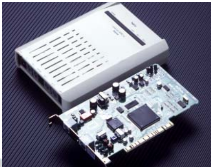
写真は日本電気株式会社 (NEC) 製のアナログポート、S/T点端子を各2つずつ装備したDSU「COMSTARZ DSU A2」(上)と内蔵ターミナルアダプター「Aterm IB55 ProII」(下)。
