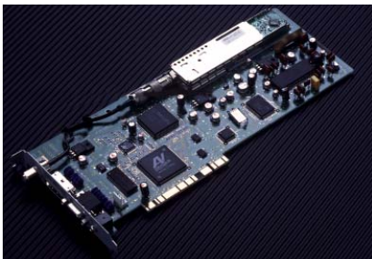
TBSが採用している、「ビットキャスト」受信カード。写真は日本電気株式会社（NEC）製の「PS98-7442-C1」
