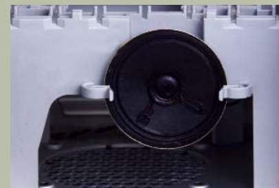
① パソコンに内蔵されているスピーカーはこんなに貧弱だ。しかも、1つしか付いていないのでモノラルサウンドしか流れない。
