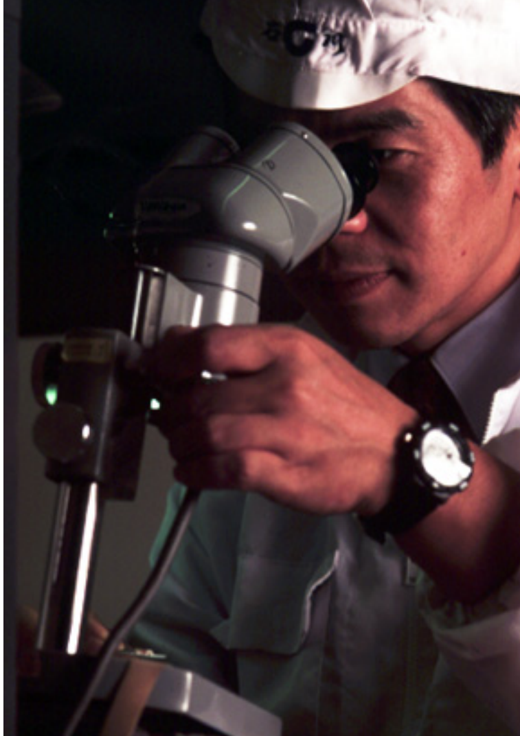
文字盤に取り付けたムーブメントを顕微鏡で見ているところ。
