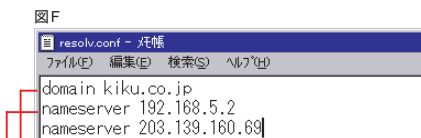
この部分にデータを「domain <データ①>」を追加する。 この部分には「nameserver <データ②>」を追加する。
