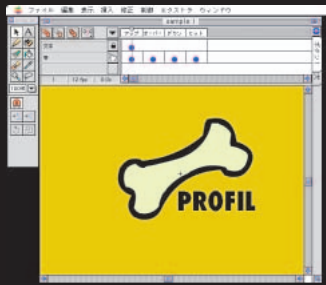
図17：ボタンオブジェクトの実体は4フレームからなるパラパラアニメーション。「アップ」は通常時のボタン。「オーバー」は反応領域にマウス
