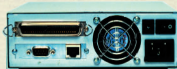
②左からSCSIポート(上) シリアルポート(9ピン) 10Base-Tポート、フラッシュRAM切り替えスイッチ、電源スイッチ。
