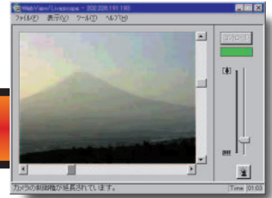
WebView/Livescopeのコントロール画面。縦・横のコントロールバーでカメラをリモート操作。右の縦のバーでズームができる。
