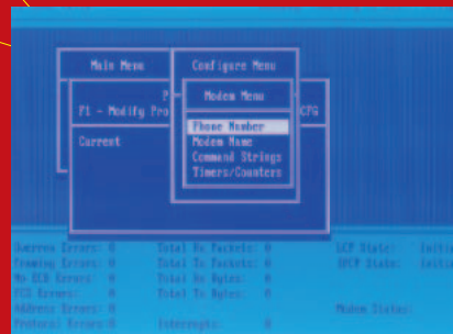
▲ 「F1」を押して各設定をする。「Phone Number」で電話番号を入れる。
