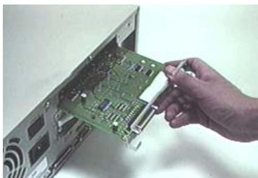
1 高速シリアルボードをパソコンにセットし、TAとパソコンをつないでいるRS-232Cケーブルのパソコンにつながっている側のコネクタを抜き、ボードのシリアルポートに差す。
