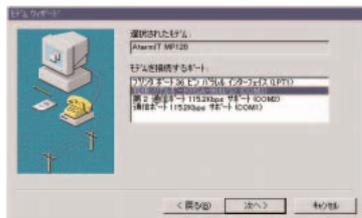
6 ポートの選択画面になる。高速シリアルボードに割り当てたCOMポートを指定しよう。アイ・オー・データ機器の場合、PC/AT互換機の場合は「Com5」、PC-98の場合は「Com3」に自動的にになるので、それぞれ正しいポートを指定する。「次へ」を押すとインストールが始まる。
