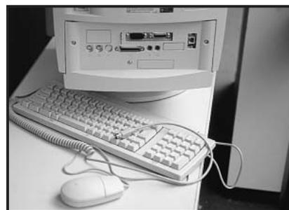
マシンの裏側(上)と中のボードを取り出したところ(右)。右写真中央に見えるカードがWindowsを起動させるためのPC互換カード。Performaには7インチのほうのカードを使う。
