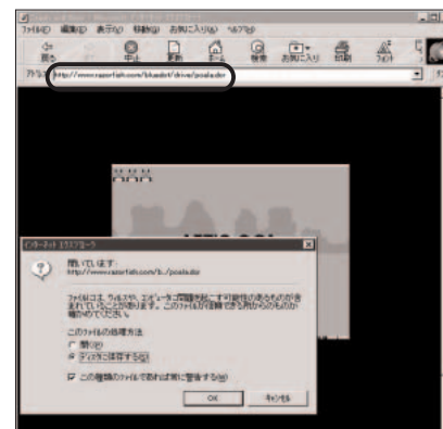
図8 ショックウェーブファイルをダウンロード 図7のファイル名をブラウザに表示されているURLに追加して、このファイルを直接指定する。ここではhttp://www.razorfish.com/bluedot/drive/drive.htmlをhttp://www.razorfish.com/bluedot/drive/poala.dcrに書き直した。ここでリターンキーを押すと、この画面が表示されるので、先ほどダウンロードしたhtmlファイルと同じ場所に保存する。なお、htmlファイルでディレクトリを別の場所に指定している場合は、ハードディスクの保存場所に合わせてhtmlファイルを修正する必要がある。
