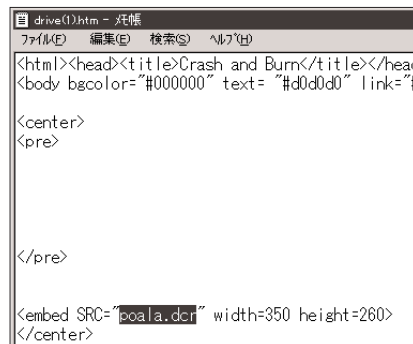
図7 ショックウェーブファイルの名前を調べる。 このページのソースを表示してx.dcrという拡張子のファイル名を探し、ショックウェーブファイルが置かれているディレクトリとファイル名を調べる。ここではpoala.dcrというファイルがルートディレクトリ(このページのhtmlファイルと同じディレクトリ)に指定されていることがわかる。これをコピーして図8へ。
