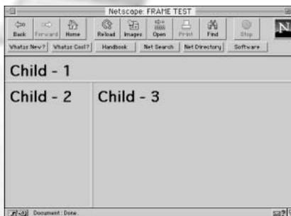
図2：フレームで画面を上下、左右に分割した例 FRAME SET を入れ子にして作成する
