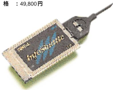
このInfoShuttle PC30iも、2つのBチャンネルを使った128Kbpsの同期通信が可能だが、マルチリンクPPPはサポートされず、独自の方式で、同社のルーターRT-100iとのみ通信が可能である（自動的にコールバックを行う機能も同様）。このため、プロバイダーとの接続に利用する場合には同期64KbpsのTAとして利用することになる。評価時点で、同社のWWWサーバーには、Windows95のISDN Accelerator Pack（Microsoft社提供）に対応した
