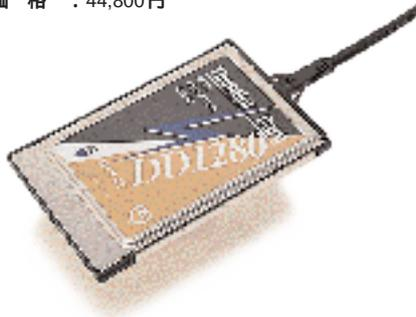
Thunder Card DD1280は、今回評価したカード型TAの中で唯一128KbpsのマルチリンクPPPが利用できるものだが、評価の時点で、マルチリンクPPPは、Windows 3.1でインターネットCameleonと組み合わせて使った場合のみがサポートされており、Windows95では、同期非同期変換機能を使った64Kbpsの同期接続だけが可能である。また、このThunder Card DD1280は、非同期接続に対応していない。
