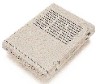
TA777もMN128に次いで、同期非同期を備えた低価格TAとして登場した。2つのアナログポートを備え、V.120にも対応している。背面パネルを見て気が付いたのだが、ヒューコムのものでよくにている。DIPスイッチのフタの構造、DIPスイッチの役割など同じで、よく見ると内箱もそっくり、ACアダプターも同じものであった。ただし、前面パネルや放熱穴のデザインなどは違っている。また、ATIコマンドで返される製品識別コードやファームウェア
