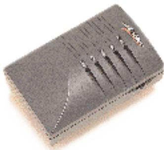
LINKBOY POCKETは、小形で電池駆動が可能なTAである。いわゆるモバイル使用を前提としているため、アナログポートなどはなく、デジタルポートのコネクタも特殊な形状になっている(専用のRS-232Cケーブルが付属する)。LINKBOYシリーズは、ウィンドウズ95登場以前に発売されていたため、この機種のドライバーは、ウィンドウズ95のインストールディスクに最初から入っている。
