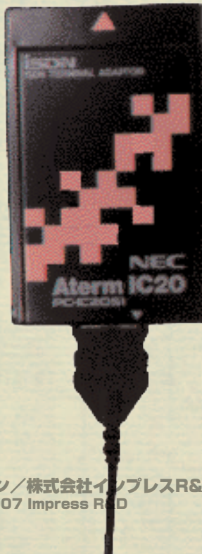
④ コネクタの付け根は差し込む方向を間違えないように三角印が付いている
