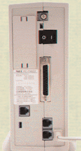
② 裏から見たところ。上からアース、電源スイッチ、シリアルコネクタ、ISDNポート、アナログポートが2つ。左上のカバーを開けてS点ユニットを装着する
